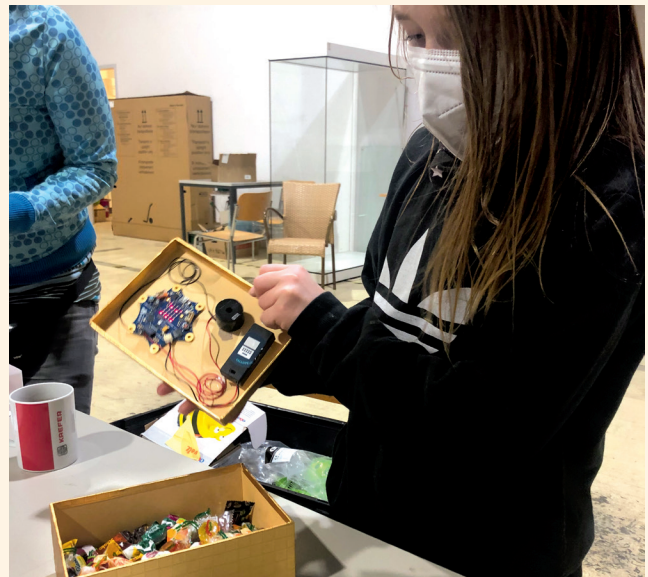
Süßigkeitenbox mit Alarmanlage – der kleine Computer ist mit einem Lichtsensor ausgestattet und so programmiert, dass ein schriller Alarmton ertönt, wenn der Deckel angehoben wird
